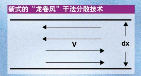
采用新式的"双向快速流动法",利用短距离的 气流方向的变化产生强劲的剪切力,避免颗粒破碎,达到良好的分散效果
