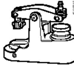
ASK51 行程逆变器 - 执行器上的 0 % 行程对应阀门 100 % 行程 - 安装在阀门和执行器之间 1)
