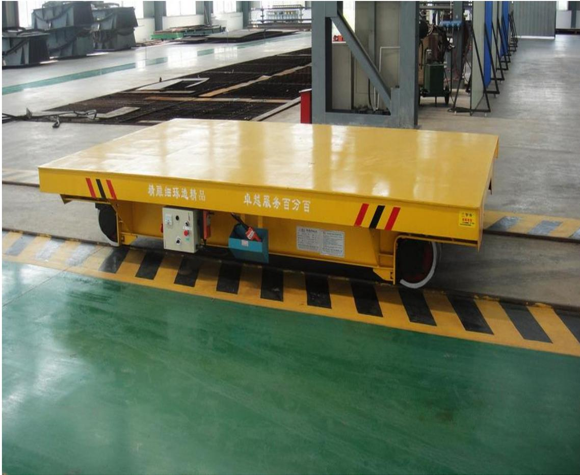
该不锈钢工厂此次订购电动搬运车主要是在铁合金加工车间应用：铁合金加工车间是将成品合金原料：镍板、锰等稀有金属加工后运到电炉的堆料口，由于镍板较重，需要用电动平车来运送，滑触线电动平车是将镍板运送至切板机，切割成约20cm宽，80cm长的长条状，再用小剪板机剪切成约50\*50cm左右的方块，经输送带传送到电炉里。
