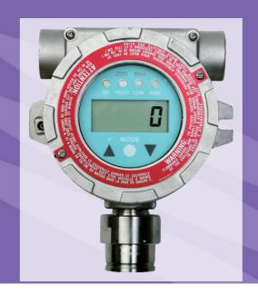
RAEGuard<sup>s</sup> LEL 是一款隔爆型、采用智能数字化传感器检测技术、固定安装方式的可 燃气体检测仪。仪器采用催化燃烧传感器,可以检测多种可燃气体。在外部功能上,仪器 采用四位 LCD 液晶显示和 4种 LED 状态显示,可现场显示测量气体的浓度值及检测仪的 工作状态。
