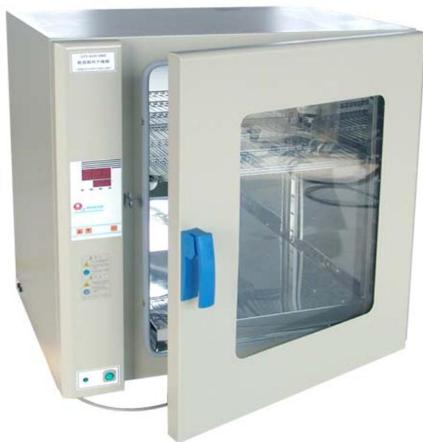
具有因停电，死机状态造成数据丢失而保护的参数记忆，来电恢复功能。外壳采用冷轧钢板制造，表面静电喷塑；本机温控系统采用微电脑单片机技术，系统具有控温、定时和超温报警等功能；合理风道和循环系统，使工作室温度均匀度变化小；采用双屏高亮度数码管显示，触摸式按键设定调节；内胆均为镜面不锈钢材料制成，半圆形四角设计使清洁更方便；工作室搁架可随用户的要求任意调节高度以及搁架的数量；采用进口电机及风叶，具有空气对流微风装置，内腔空气可以更新循环；箱门具备大视角观察玻璃窗
