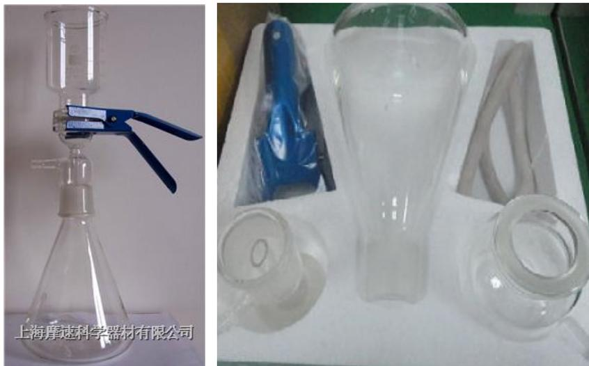
300ml 漏斗，铝合金夹子，直径 47mm/50mm 砂芯，1L 抽滤瓶 750.00/
