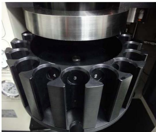
关参数，即可计算样品的渗透率，无需压力稳定。它适合测量各种范围的渗透率，特别是低渗透样品。而且测量速度较快。CMS-300 以波义尔定律，并结合先进的标定技术，测试岩芯
