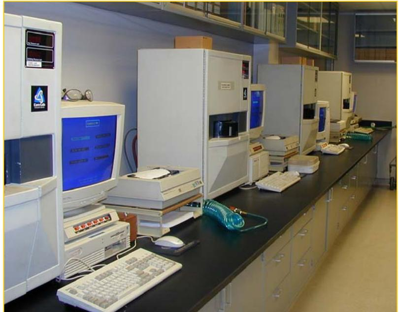
CMS-300采用非稳态压力脉冲衰减法技术进行渗透率和孔隙度联测，测试速度快，测试岩心样多，自动化程度高；系统采用达西-克氏-费氏综合计算模型，以及改进型波义尔定律，并结合先进的标定技术，测试渗透率和孔隙度等参数。CMS-300不仅适合中高渗透率样品，而且特别适合不服从达西定律的低渗透样品。
