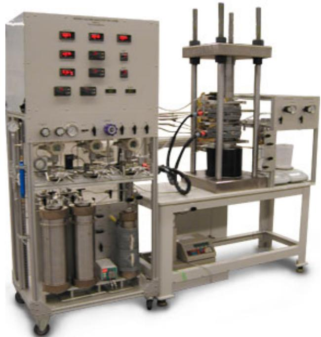
裂缝导流评价系统是用来在试验室确定井底条件下的支撑剂层的裂缝导流能力或渗透率。根据需要，其试验可在闭合应力 20,000 psi(140 MPa)和温度 350°F (176°C) 下使用盐水或气体进行。它可以确定作为支撑剂，压裂液，产出烃类型或速度之函数的长期裂缝导流能力。该系统还可作以下选择：
