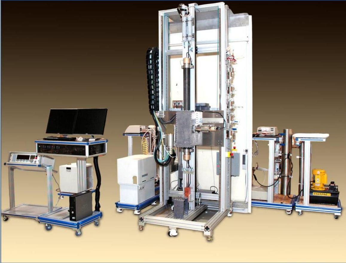
LXRS-400型X射线扫描岩心流体饱和度变化规律在线检测实验系统最早是与世界上主要的石油研究中心和大学联合开发研制。它提供了一个计算机控制的自动X射线线性扫描台，可在地层条件下进行岩心流动试验时，对装在一个可穿透X射线的岩心夹持器中的岩心样品进行遥控扫描。该系统用于油藏高温高压条件下，进行两相流稳态或非稳态驱替流动试验。在试验过程中，采用计量泵注入“活性”地层流体或者实验室流体，X射线线性扫描监控实时饱和度，下游产出流体计量，回压调节器控制回压，计算机控制试验过程并采集数据。
