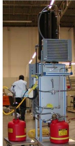
自动 CO<sub>2</sub>-甲苯清洗式岩心清洁器是一种由计算机控制的用户友好型系统，旨在运用高效的程序化循环中的 CO<sub>2</sub> 饱和甲苯清洁栓塞大小的全直径岩心样本，以去除残留的碳氢化合物。该系统包含一个计算机、控制面板、CO<sub>2</sub> 和调节器、甲苯泵、加压 CO<sub>2</sub>/甲苯饱和罐，以及一个 24" 的不锈钢岩心清洁压力室（可调节直径长达 4 3/8" 的岩心样本）。但并不包括甲苯。列明压力和频率。可选双室系统。
