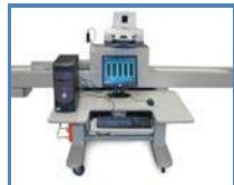
除了测试特定元素的自然放射性外，还能测试岩心样品的总伽马和总密度。重点选择铀、钾和钍。该仪器用于测试岩样的全自然伽玛放射性。该仪器配有一个马达传送带，可扫描多个岩样，并将记录的伽玛放射性数据存入计算机，相对岩样长度作图，该图可与实际测井曲线对比，以便精确地确定岩样埋藏深度，以及判断岩样层段是否有缺失。该仪器配有：扫描台、计算机和标定件。
