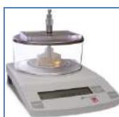
该仪器采用反向拉力法测量表面张力，与传统的环法和挂片法不同，它用一根不易损坏的不锈钢杆来进行测量，其结构坚固耐用，稳定性好。在每次测量前可以用标准化化学药品清洗，或用手工擦拭而不会损坏。测量范围是 0~250mN/m，测量精度达 0.01~0.1mN/m，可供选择的型号有：手工操作的 101 型；半自动的 102 型；全自动的 301 和 302 型。各型仪器均配有数据分析软件，还可选用 ADP-100 型转换头来进行传统的环法和挂片法测量，以便测量界面张力。
