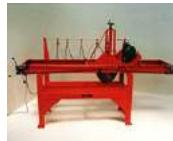
坚固的底盘保证了转矩最小化。可调整刀片组可进行精确切割。V型皮带驱动，提供了较长皮带寿命和有效传输功率。细微的进刀速度（由链条和链轮手动控制）。为了安全起见，开关位于操作者附近。滑轮悬浮冷却液管保证了加到刀片上的适量冷却液。可调整进深系统确保完成恰当的切割深度。
