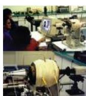
挂滴式表面张力测试系统可在压力 70MPa 和温度 177°C 的油藏条件下测试地层流体的表面张力，测试室配有 6 种不同内径的可互换针头。其测试范围为 10~3~90mN/m。该系统配有无振工作台、加热系统、活塞中间容器、计量泵和带有照相机的显微镜，用于成像、记录和分析。
