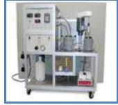
该仪器用于测量酸化作业所需的酸岩反应和金属材料在酸中的腐蚀速率。它可以用手工或自动操作，待测的岩样或金属试件被安装在旋转轴上，然后浸没在酸液中，通过磁力搅拌的方式进行动态测量。所模拟的温度达 250C，压力达 21~50 MPa，反应釜的体积有 300、500 和 1000ml，其温度、压力和取样均由计算机控制自动运行。
