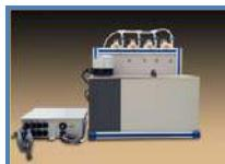
该仪器是一台 69Mpa 的高压仪器，设计用于页岩或煤岩样品的气体吸附等温曲线测量或储气能力的评价。仪器包括一个数字式控制加热油浴，可精确控制温度高达 350°F (177°C)。油浴中安放三个吸附测试室。页岩或煤岩样品首先进行粉碎，然后用 40-120 目的筛网筛选，将 80-100g 的经筛选的样品放入测试室中进行测试。每个测试室可在压力高达 69MPa、温度高达 350°F (177°C) 下进行测试。
