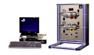
该系统使用氮气或甲烷作为测试气体,可以用于不同测试气体的渗透率研究。由于气体流量很低,气体惯性滑脱效应被降低到最小。
