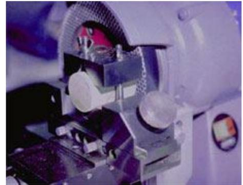
该台式端面磨床将与精密加工的 V 形块样本夹持器一起提供，适用于直径为 1 英寸和 1.5 英寸的样本。在处理过程中，可选轮冷却润滑系统可用于去除样本中的“岩末”。
