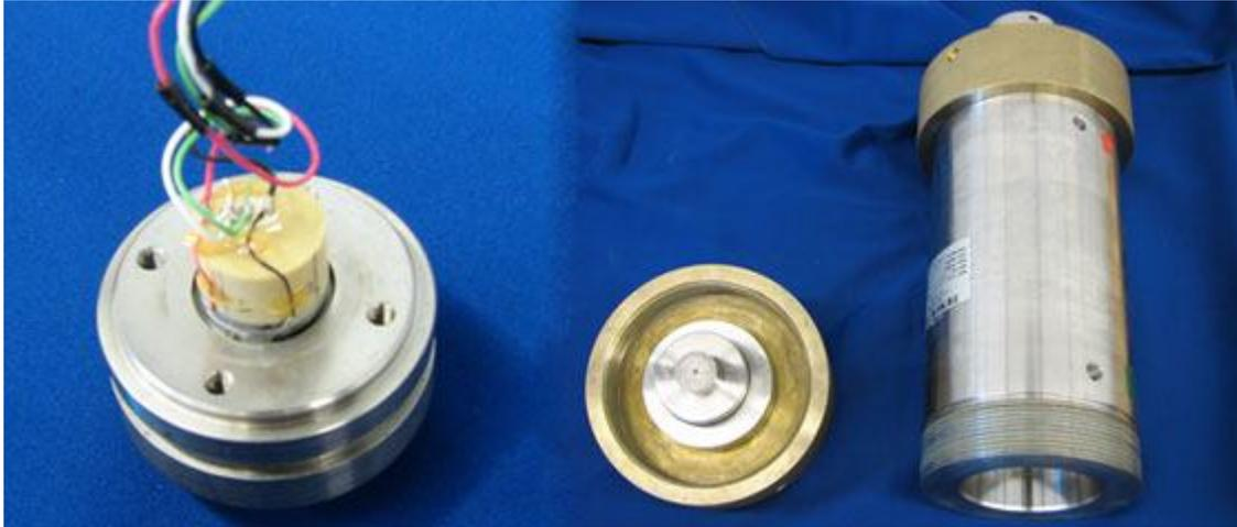
在储层位置进行测井测量期间进行声速测量。岩心夹持器用于在实验室中在储层条件下测试岩心样本。岩心夹持器含有一对绝缘传感器。
