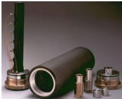
X 射线和伽马扫描测量可广泛用于分析储层内的流体流动特性。这些岩心夹持器都适用于该项应用。这些岩心夹持器提供一个用碳纤维复合材料包裹完好的铝复合体。该铝复合体吸收的 X 射线或伽马射线少于全铝岩心夹持器，比碳纤维环氧岩心夹持器的性价比要高。其吸收量较少，因此在高压下也可进行双能量研究。该铝复合体穿过岩心长度的厚度均匀，因此很容易测量。岩心夹持器的内部零件可能与哈斯勒型、双轴向、三轴向或测压孔岩心夹持器相似。如需更多详细信息，请参考 RCH、HCH、TCH、或 DCH 系列目录表。
