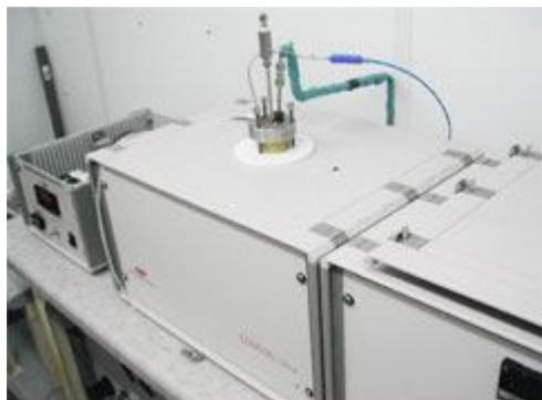
作为 NMR 和 X 射线应用岩心夹持器的世界领先企业，我们很高兴地宣布推出全新系列的复合岩心夹持器，这些岩心夹持器可与低场 NMR 仪器配合使用。这些岩心夹持器提供全新的玻璃纤维和 PEEK 复合体。这种新设计具有下列显著优点。
