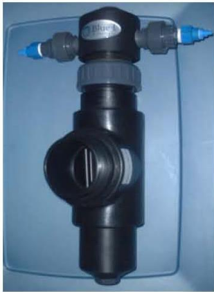
图5: 浊度传感器和带去泡器的水流槽
