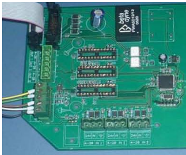
图6: 将浊度传感器连到浊度模块
