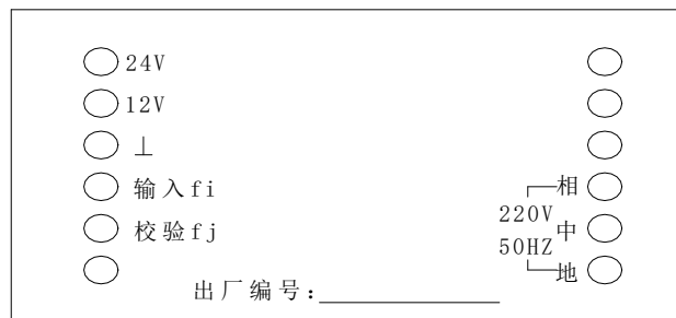
图 8.6 XSJ-202型后面板接线示意图
