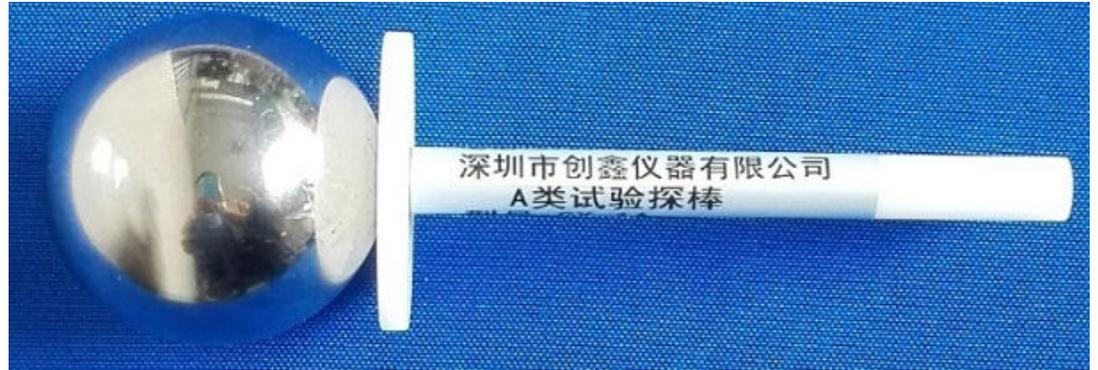
6、根据 IEC61032 图 1(Test probe A) 、GB/T4208-2008 表 6（第一位特征数字 1）
