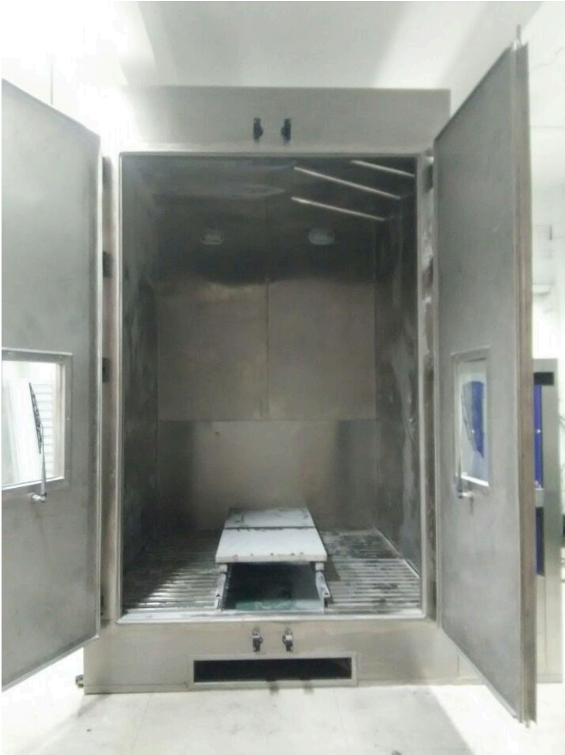
砂尘试验房内部实物图片
