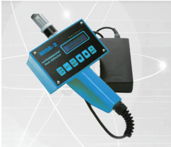
NASA-2 是一款手持式颗粒物检测仪，可以用于测量工作环境或烟气中的颗粒物浓度。适用于环境监测、气象研究、建筑物内颗粒物浓度测量等领域。仪器通过激光法检测颗粒物的大小和浓度（最大能够检测  $600\text{mg}/\text{m}^3$ ），反应迅速，测量值精确，即使在很低浓度下也能正确测量。仪器每秒都会更新测量数据，因此也可用于检测过往车辆的烟尘排放。在测量时仪器会自动连续显示 TSP、PM10、PM4、PM2.5 和 PM1 浓度，不用加装任何过滤器，使用方便。
