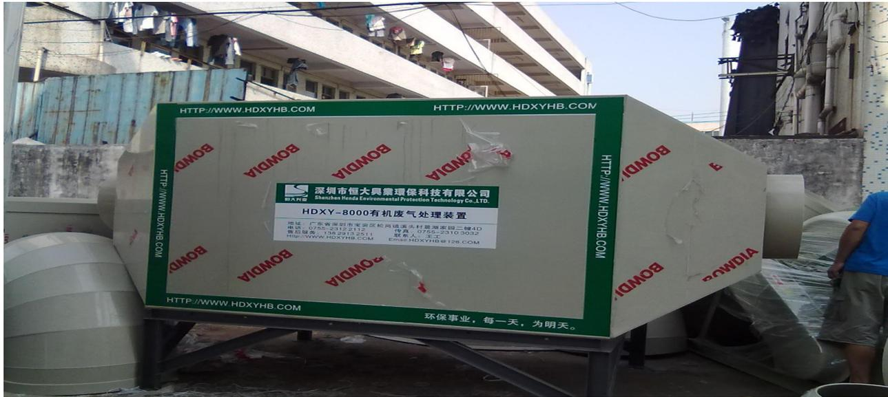
该洗涤塔的填料采用PP材质，形状为多齿TELLERTTE形，空隙率达到95%，比表面积达90平米每立方；除水层的填料采用PP材质，形状为圆弧TELLERTTE形，空隙率达到9（勤加缘网络商铺）5%，比表面积达180平米每立方。洒水头采用PP120度旋转无堵塞喷头。系统里无金属组件。为此，全系统具有极高的耐强酸碱性；全系统的阻力小于40mmAq，大大节约了能源的消耗量。
