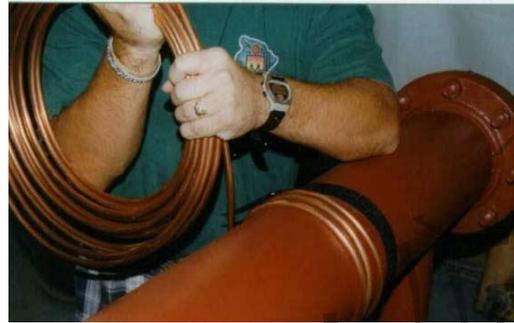
将铜管缠绕于 8 英尺管道上
