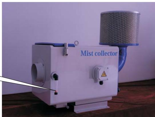
当油雾收集器运行时红色球向上浮动到顶部,油雾收集器运行一段时间后,设备内的过滤网上沉积大量油雾杂质,导致吸风量变小,红色小球就会下降,提示需要及时清洗过滤网
