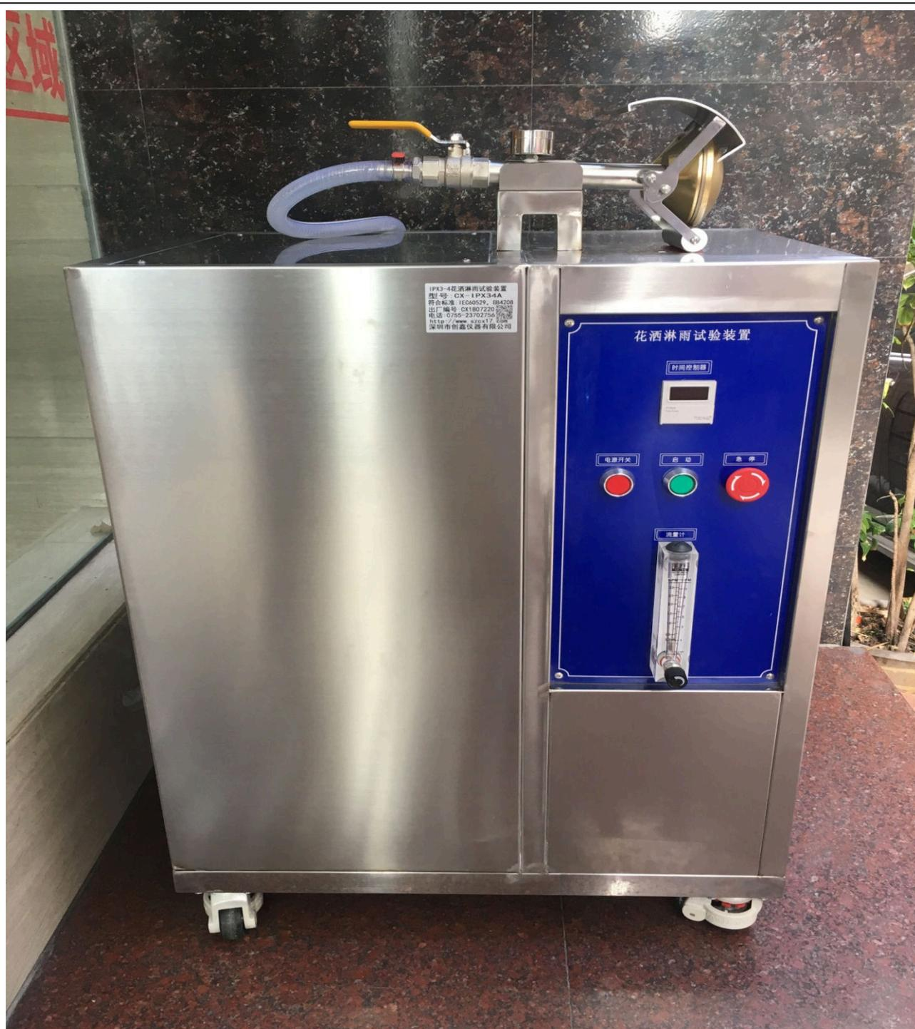
手持式 IPX34 花洒淋雨试验装置实物图片
