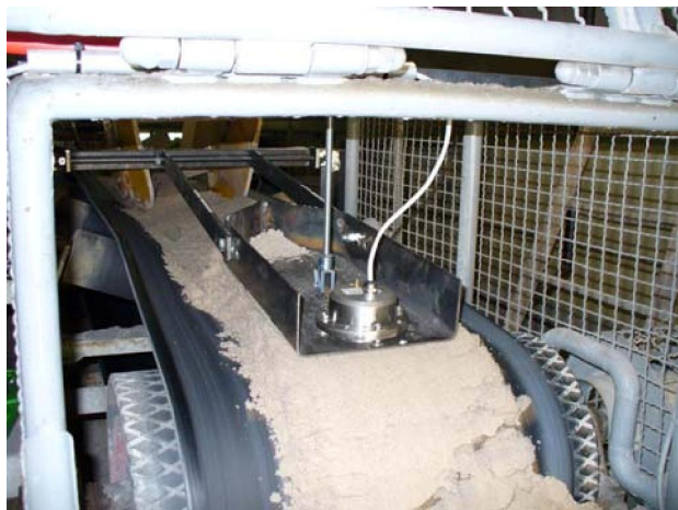
带有配件的传感器HUMY3000用于物料流的连续性检测
