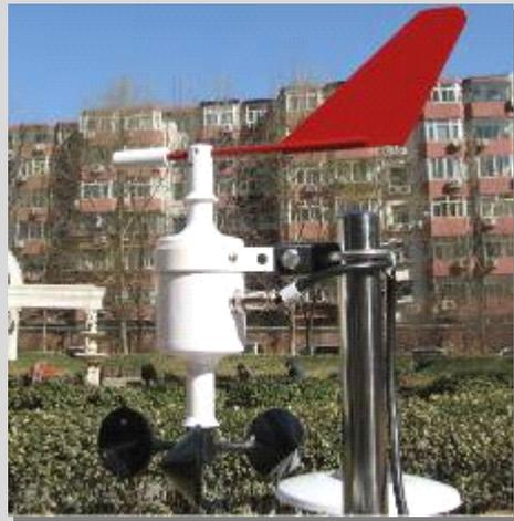
风速传感器的感应元件为三杯式风杯组件，信号变换电路为光电转换电路。在水平风力驱动下风杯组旋转，通过主轴带动磁棒盘旋转，其上的数十只光电管通过旋转码盘感应除脉冲信号，其频率随风速的增大而线性增加。
