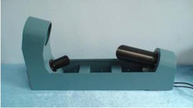
该仪器可用于移动载体和固定站点，主要应用于船舶、高速公路等交通运输部门。该能见度仪结构简单、工作稳定性好、可靠性高、能耗低，使用维护方便。
