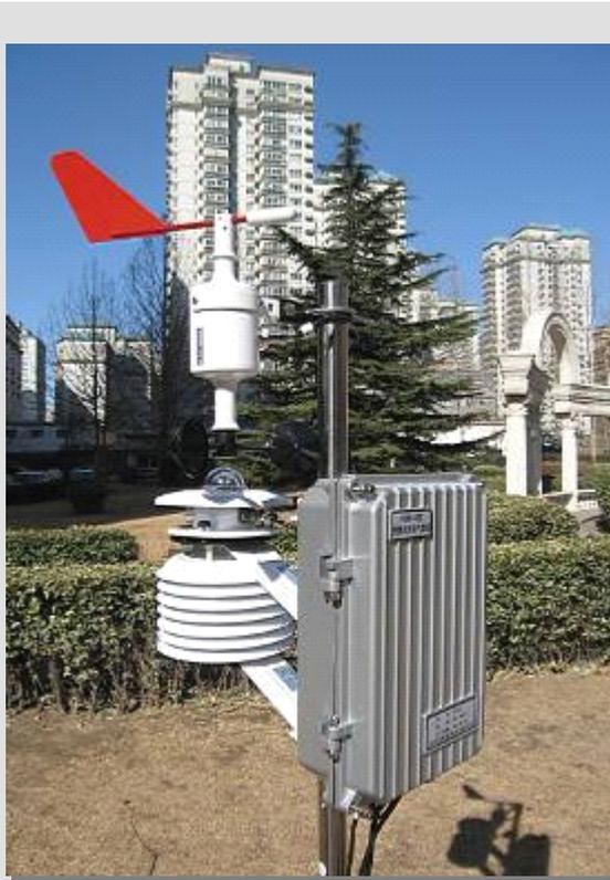
工作环境：温度：-50~80℃，湿度：100%，抗风等级：≤75m/s。观测支架有三脚式和车载式两种，采用不锈钢材料制造，表面光亮处理，在腐蚀气候环境下永不生锈，重量小于5KG，携带方便，精巧的工艺为现场增加一道灿烂的亮点。
