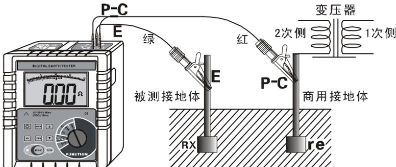
简易法测量接地电阻，其仪表读数为被测接地体的接地电阻值与商用接地体的接地电阻值之和，即：
