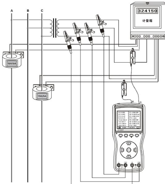
测试时，可以根据各种相位关系判断感应容性负载、相序、极性，若 U11 相位显示在  $0^\circ \sim 90^\circ$  范围，则被测负载为感性，显示在  $270^\circ \sim 360^\circ$  范围，则被测负载为容性；若显示相位都接近  $120^\circ$ ，则为正相序，且极性相同；若显示相位接近  $120^\circ$  和  $300^\circ$ ，则为正相序，且极性相反(可能有电流钳夹反或线路接线反)，其他情况为反相序(不考虑缺相)。
