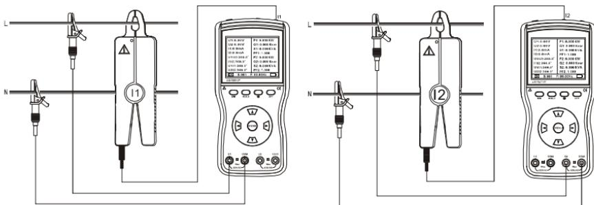
三相四线测试：分两个步骤接线可以测试完三相四线的电压、电流、相位、相序、频率、功率、功率因数等，对应接线见下表及图。（**仪表 2 个 COM 端内部是短接的，任一个 COM 端接到零线 N 即可**）。
