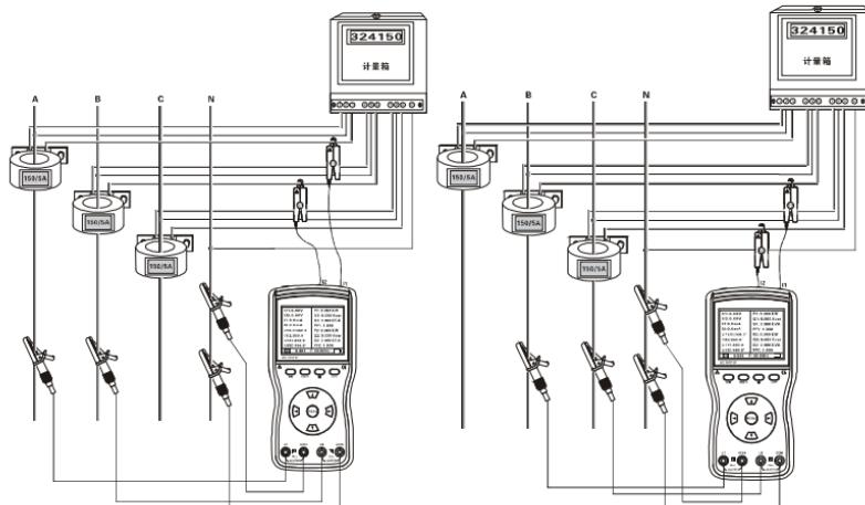
三相三线测试：将被测电压线 UA 黄、UB 绿、UC 红对应接入仪表的 U1 红、COM 黑、U2 红插孔，电流钳 I1、I2 对应钳住被测线路 IA、IC，可以测试三相三线电压、电流、相位、相序、频率、功率、功率因数等。参考接线见下图。(仪表 2 个 COM 端内部是短接的，任一个 COM 端接到零线 N 即可)。
