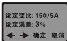
开机后，按向下箭头键启动报警功能，LCD 显示一个三角形符号，若实际测试的比差超过设定误差，仪表发出报警蜂鸣声。
