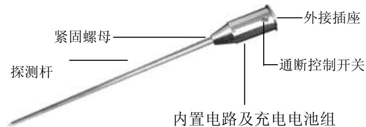
JT-TLD 型 听 漏 棒 构 成 图
