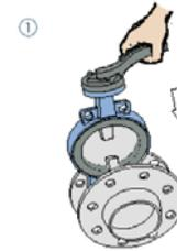
1. 将阀门放置于安装的两法兰片之间
