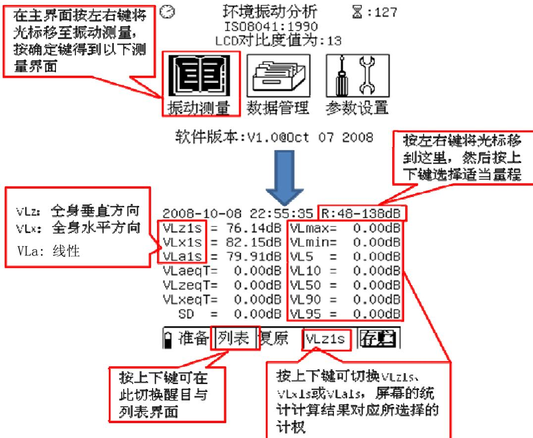
设置相关选项后, 按启动/暂停键开始测量。待积分测量时间到达后, 测量
