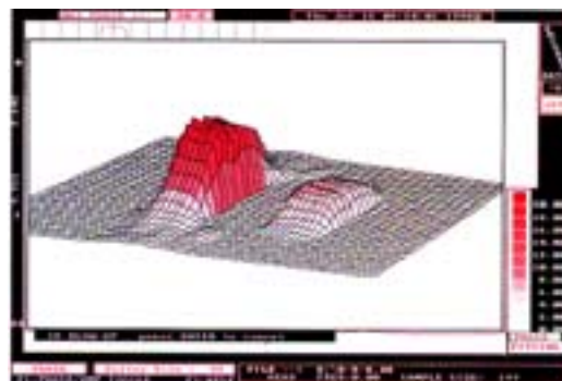
图 4 深度为壁厚 60%和 30%平缓壁减的放大显示标准图
