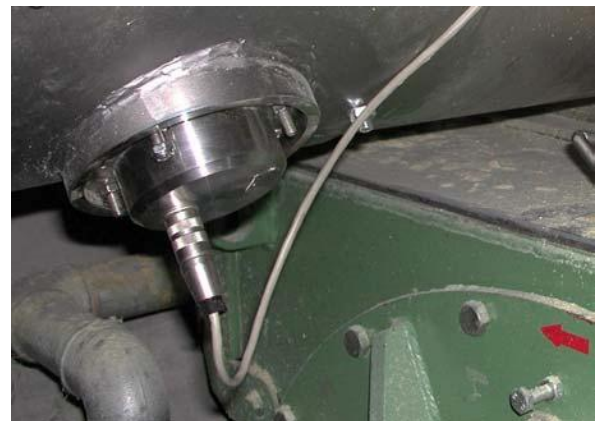
安装在螺旋输送机内用于物料流连续测量的传感器HUMY3000
