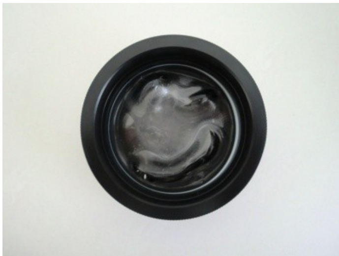
图3 装夹试样后封口的透湿杯
