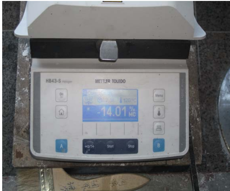
图 1 取样测量淀粉水分
