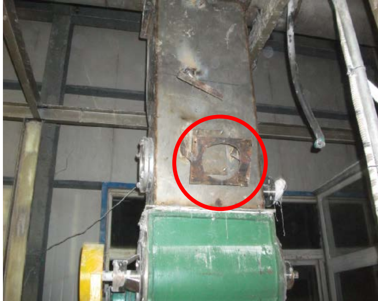
图 4 微波测量原理水分仪安装位置
