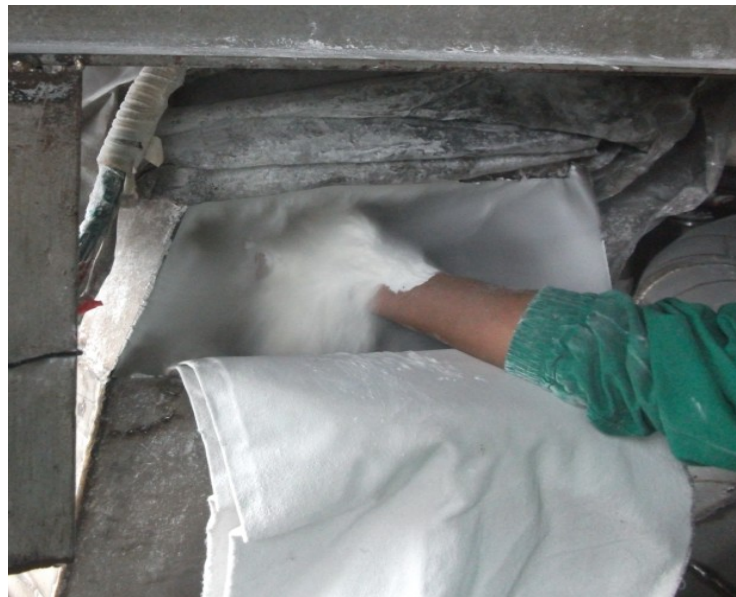
图 2 手摸方法测量淀粉水分
