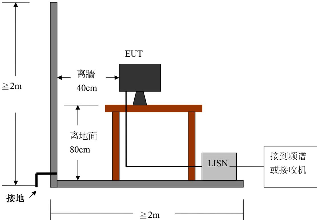
电磁兼容 EMI 传导测试场地的平面布置图。
