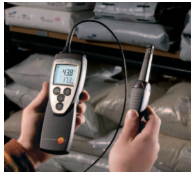
安装接线式湿度探头，测量仓库内的环境条件
