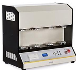
图 3 FDT-02 揉搓试验仪
