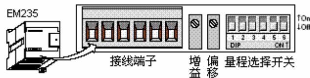
图 24 EM235 的校准与量程选择开关位置示意图
