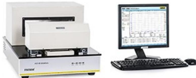
**试样准备：**将试样裁切为 15 mm × 130 mm 的长条试样，试样两端用打孔器打孔以将试样装到仪器上，
