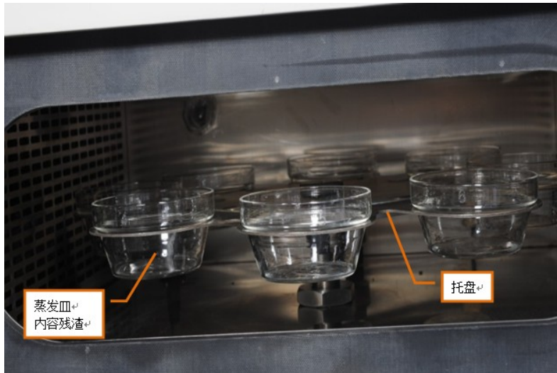
图 3 蒸发皿在 ERT-01 中的干燥过程
