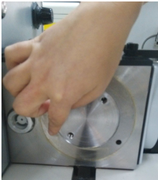
a. 涂抹真空油脂
