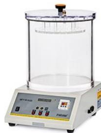
图 3 MFY-01 密封试验仪
