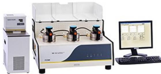
图 2 VAC-V2 压差法气体渗透仪
